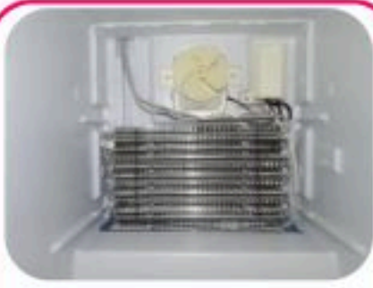
المبخر ( الفريزر ) مبادل حراري داخلي
