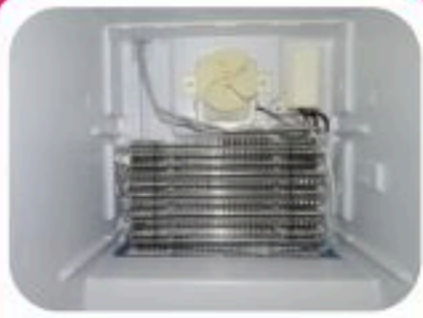
المبخر ( الفريزر ) مبادل حراري داخلي
