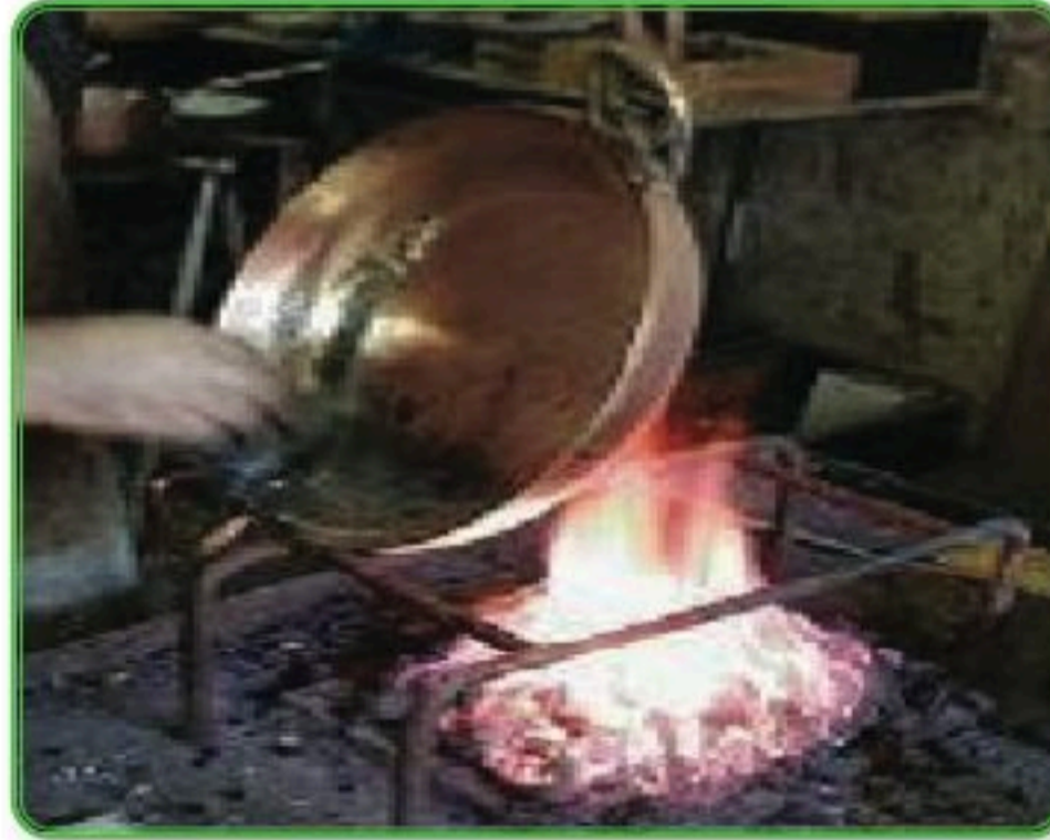
الشكل (٦٧): التخمير «تسخين المعدن لإكسابه اللدونة».
