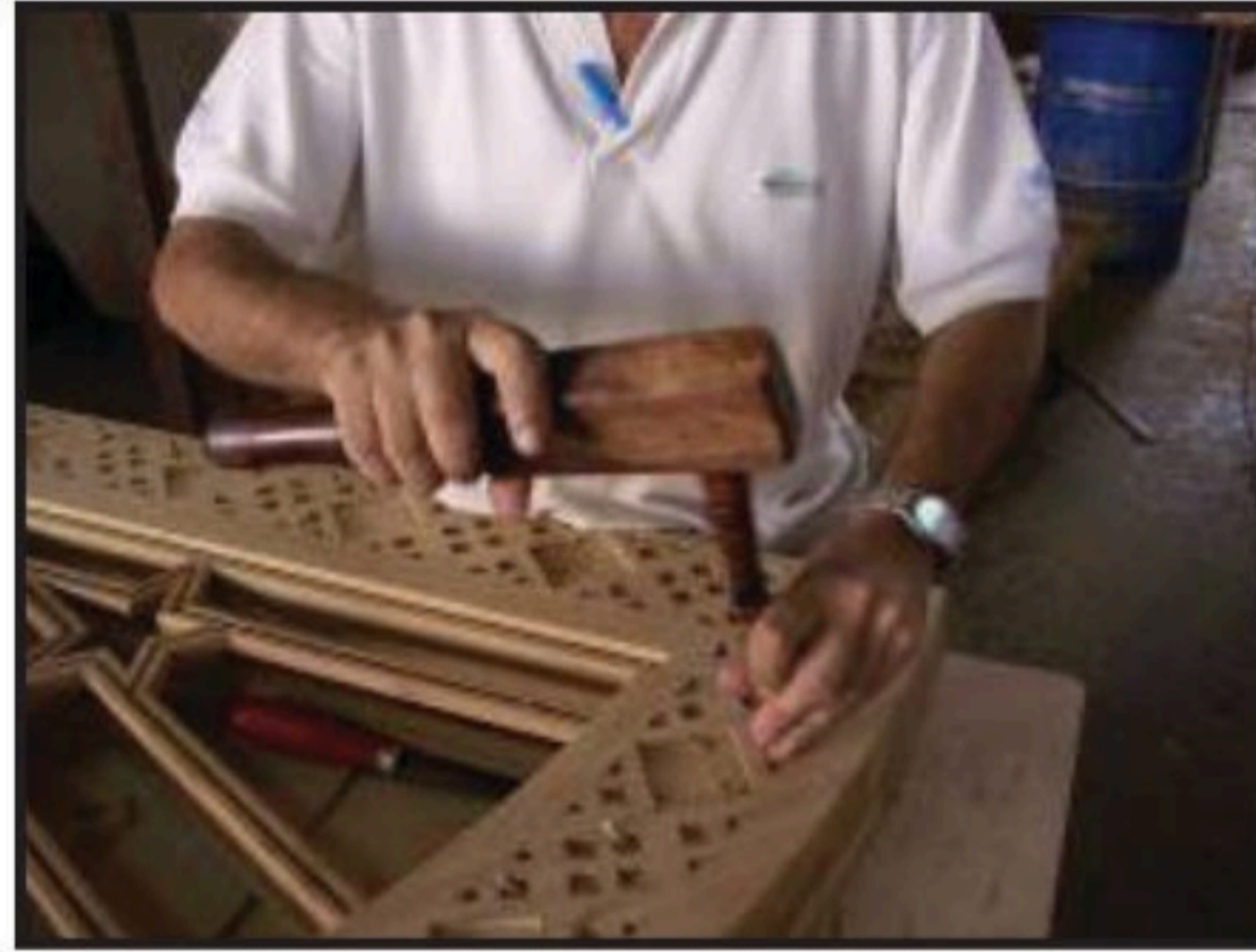
( ١ ) : استخدام المدق الخشبي ، وهي الأداة الصحيحة .
