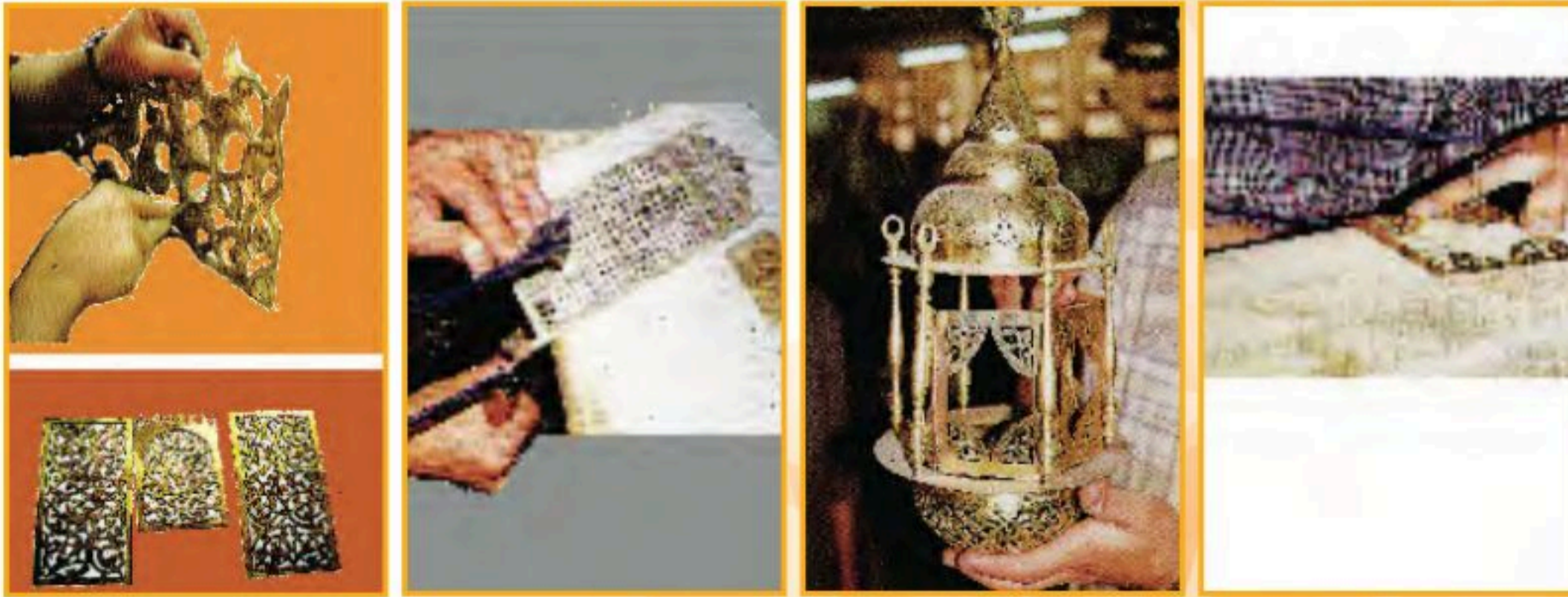
الشكل (٥٤). طرق استخدام أزاميل ومنشار المعادن
